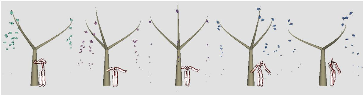
"*Je suis un arbre*": À partir de données de mouvement capturées, notre système de simulation temps-réel permet de simuler le mouvement d'une entité non-anthropomorphique (un arbre stylisé) en mettant en correspondance des descripteurs calculés sur le mouvement humain et les paramètres d'une simulation physique. Ainsi, les émotions de la personne capturée sont transmises à l'arbre qui se comporte alors de façon triste, joyeuse ou encore stressée.
