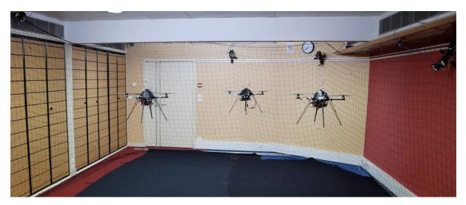
Une volière équipée d'un système de localisation optique nous permet de faire voler simultanément plusieurs drones d'intérieur. Nous vous proposons de découvrir comment ces drones peuvent être contrôlés pour former un essaim capable de se déplacer dans l'espace de travail en maintenant des contraintes géométriques de positionnement des uns par rapport aux autres pour des applications de navigation, d'exploration et de cartographie.
